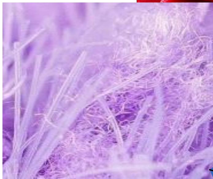
Микроволокно ИНВОЛВЕР под микроскопом
