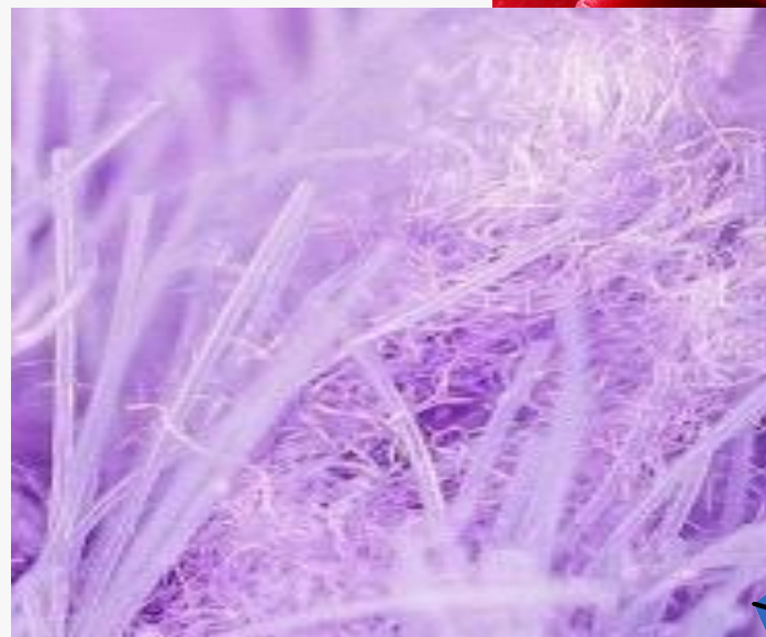
Микроволокно ИНВОЛВЕР под микроскопом
